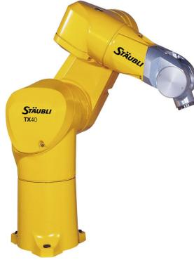
**Fig. 2.** TX40 Staubli robot.
